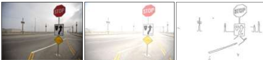
Şekil 2. Ekleme (b) ve tersini alma (c) işlemleri (Adding (b) and inversion (c) operations)
